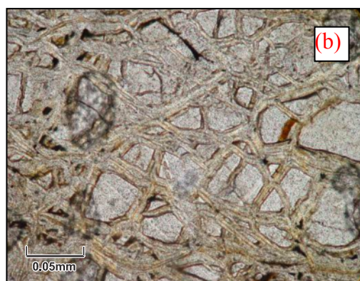
شکل ۴ تصویری از مقطع میکروسکوپی سرپانتینیت‌های نیریز با بافت غربالی (mesh-texture) و شبه ریختی‌هایی از الیون (OL) که فقط قالبی از آن باقی مانده و به سرپانتین (S) دگرسان شده‌اند. (تصویر (a) در نور XPL و تصویر (b) در نور PPL).
