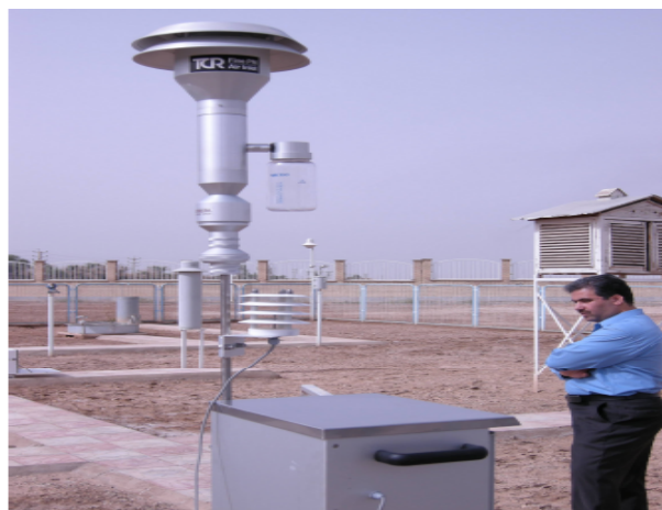
شکل ۱. نمایی از دستگاه High Volume Air Sampler مدل TCR (سمت چپ) و فیلتر سلولزی PM10 پس از نمونه برداری (سمت راست).
