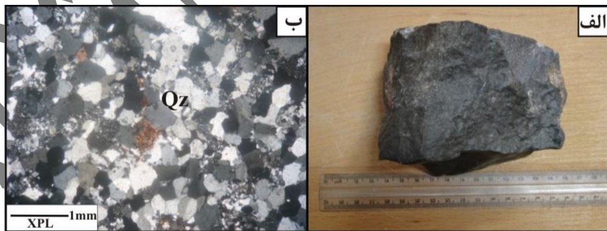
شکل ۹: الف: تصویر نمونه دستی ماسه‌سنگ‌های دگرگون‌شده در غرب گرانیتوئید قله‌ریگ [۱]؛ ب: تصویر میکروسکوپی ماسه‌سنگ‌های دگرگون‌شده پیرامون گرانیتوئید قله‌ریگ با بافت گرانوبلاستیک غنی از کوارتز [۱].
