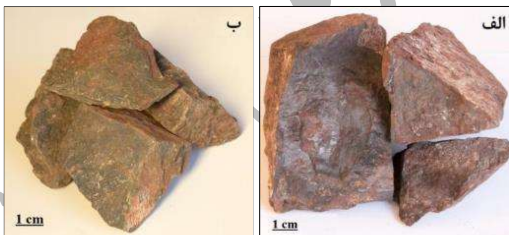
شکل ۴- نمونه دستی از بوکسیت غنی از کوندوم (الف) و غنی از آمزیت (ب)
