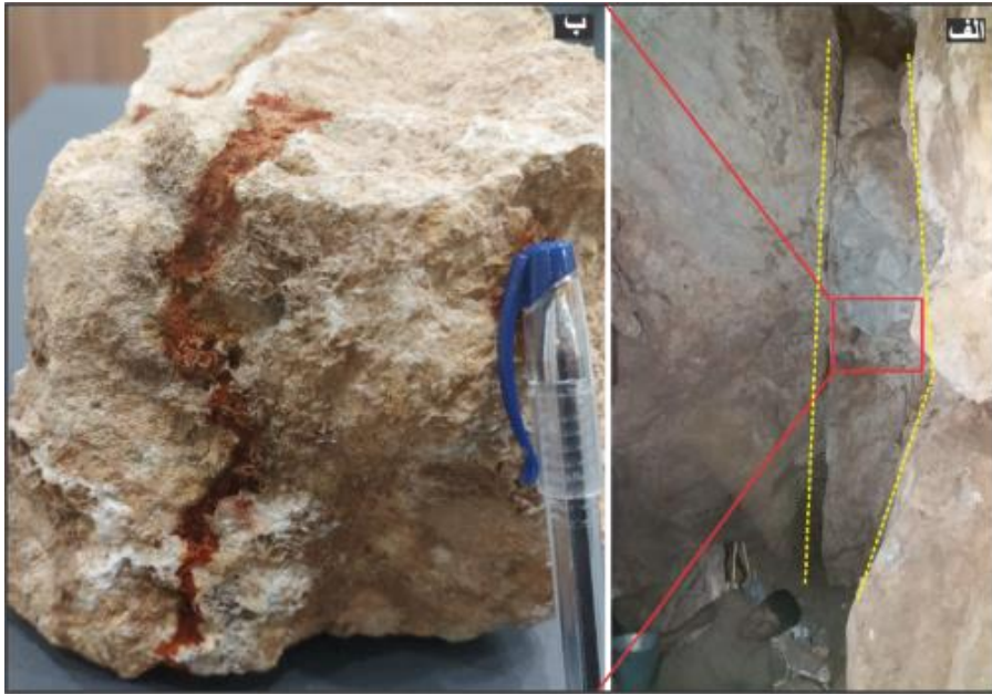
شکل ۶ کانی‌سازی ثانویه به صورت کانی‌های همی‌مورفیت، اسمیت زونیت و سروزیت انباشته در درز و شکستگی‌های تأخیری شده‌است.
