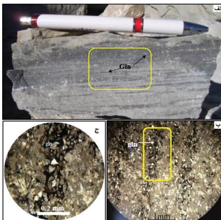
شکل ۸ تصاویر بافت شبه‌لامینه‌ای در کانسار چرلانقوش: الف) بافت شبه‌لامینه‌ای دارای کانی‌های گالن و اسفالریت در نمونه دستی (بخش‌های تیره رنگ، ب) تصویر میکروسکوپی از بافت شبه‌لامینه‌ای در نور دو بار قطبیده عبوری و پ) تصویر با بزرگنمایی بیشتر از بخش مستطیل زرد رنگ مشخص شده در شکل ب. نشانه‌های اختصاری کانی‌ها برگرفته از مرجع [۱۳] هستند.
