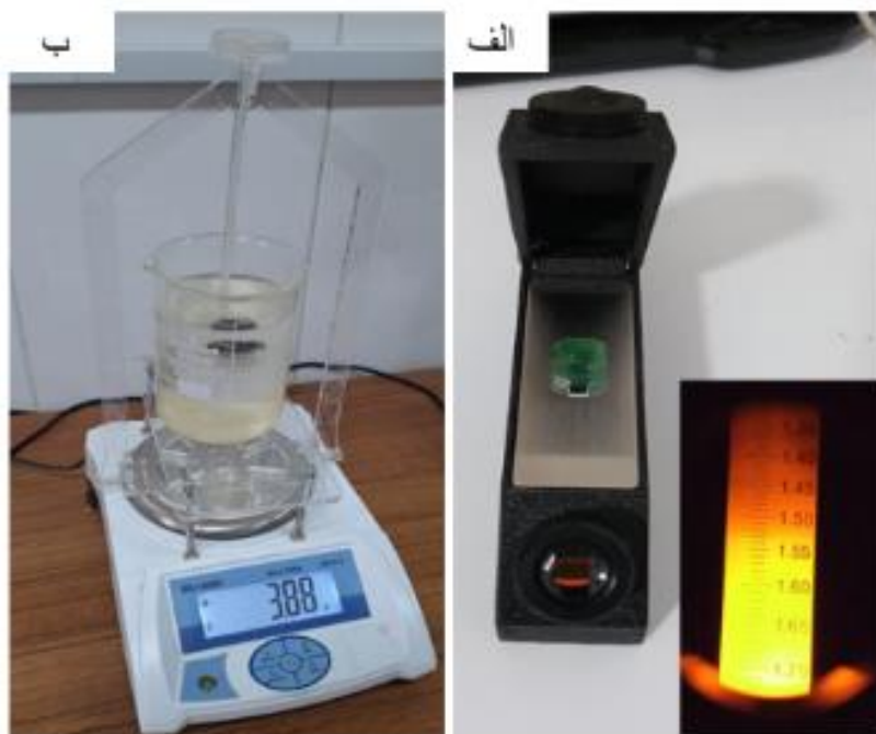
شکل ۵ اندازه‌گیری ویژگی‌های گوه‌رشناسی عقیق‌ها. (الف) اندازه‌گیری ضریب شکست عقیق‌ها با استفاده از شکست سنج، (ب) اندازه‌گیری وزن مخصوص عقیق‌ها با ترازوی ایستایی (دقت اندازه‌گیری ۰/۰۱ گرم).
