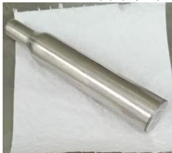
شکل ۱ بوت‌ه‌ی پلاتینی استفاده شده برای رشد تک‌بلور PIN-PMN-PT
