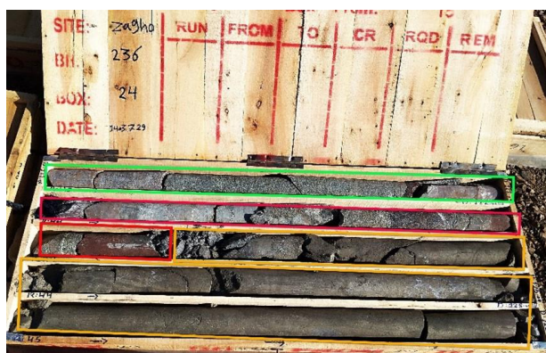
شکل ۷ تصویری از پهنه کانه‌زایی سولفید توده‌ای در کانسار سرگز از عمق ۱۲۱-۱۲۲ متری واحد آذرآواری (مستطیل سبز) و از عمق ۱۲۲-۱۲۳،۲ متری افق ژاسپری به رنگ شیری و قرمز در بالای پهنه کانه‌زایی (مستطیل قرمز) و پهنه کانه‌زایی سولفید توده‌ای از عمق ۱۲۳،۲ تا ۱۲۶ متری (مستطیل نارنجی).
