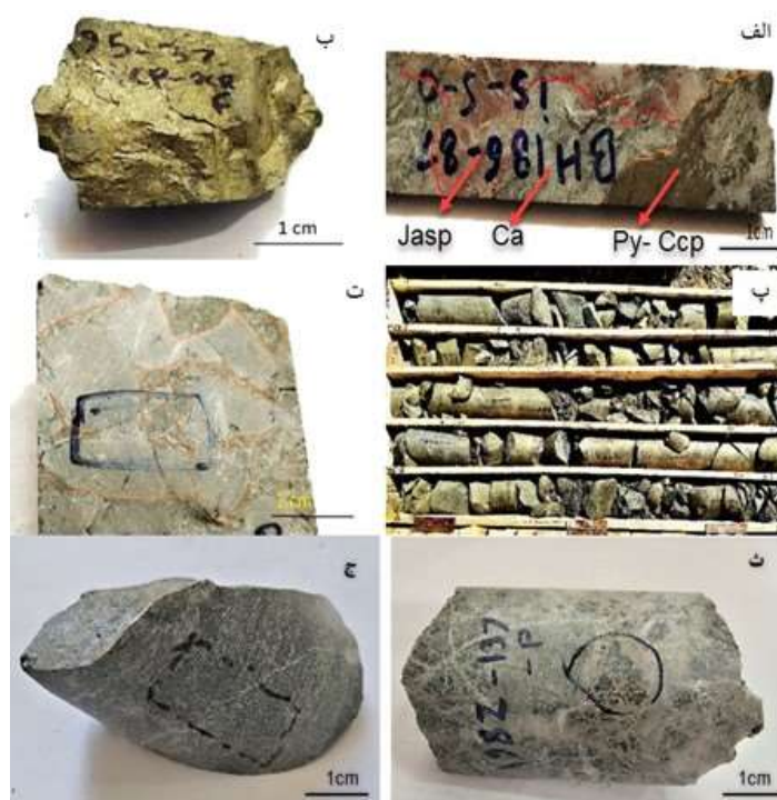
شکل ۱۲ الف- مرز بین کانه‌زایی سولفید توده‌ای با ژاسپر و کلسیت درون مغزه حفاری برش خورده که به رنگ نارنجی نشان داده شده است. ب- نمونه دستی از کالکوپیریت در پهنه سولفید توده‌ای. پ- کانه‌زایی سولفید توده‌ای درون مغزه‌های حفاری در زیر افق ژاسپری. ت- پهنه رگه - رگچه برشی درون مغزه حفاری که با رنگ نارنجی مشخص شده است. این پهنه نیز در زیر پهنه سولفید توده‌ای قرار دارد و دارای مقادیر کمی کانی‌های پیریت و کالکوپیریت است. ث- پهنه رگه-رگچه‌ای با زمینه بازالت به همراه رگچه‌های پیریتی و سیلیسی و ج- بازالت پایینی
