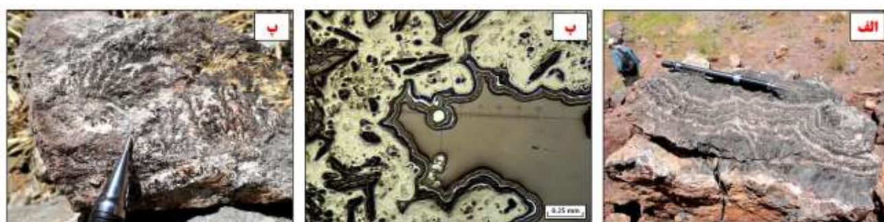
شکل ۶ الف) بافت گل‌کلمی در نمونه‌ی ب) بافت گل‌کلمی در مقاطع صیقلی بررسی شده. پ) بافت دارینه‌ای منگنز بر سطح شکستگی سنگ‌های
