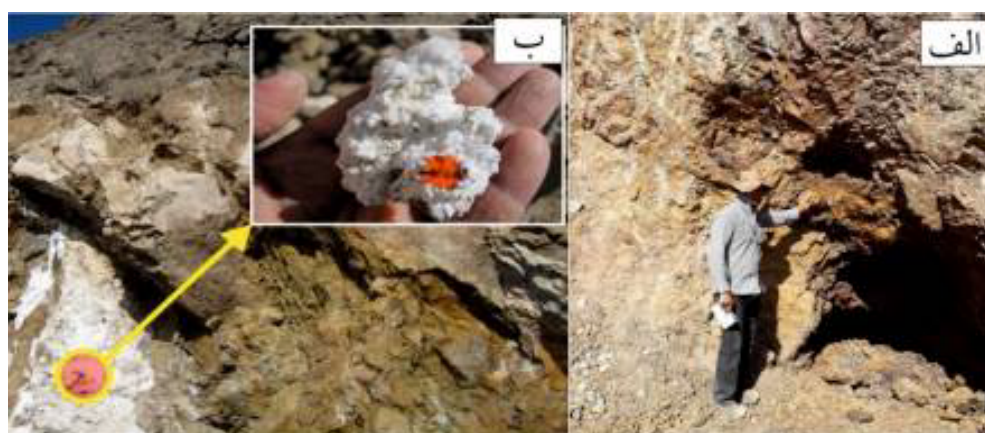
شکل ۳ الف) تشکیل کانی های اکسیدی- کربناتی- سیلیکاتی در بخش گوسنی منطقه و ب) شناسایی کانی های اکسیدی- کربناتی- سیلیکاتی روی بوسیله معرف روی (زینک زپ) در صحرا.
