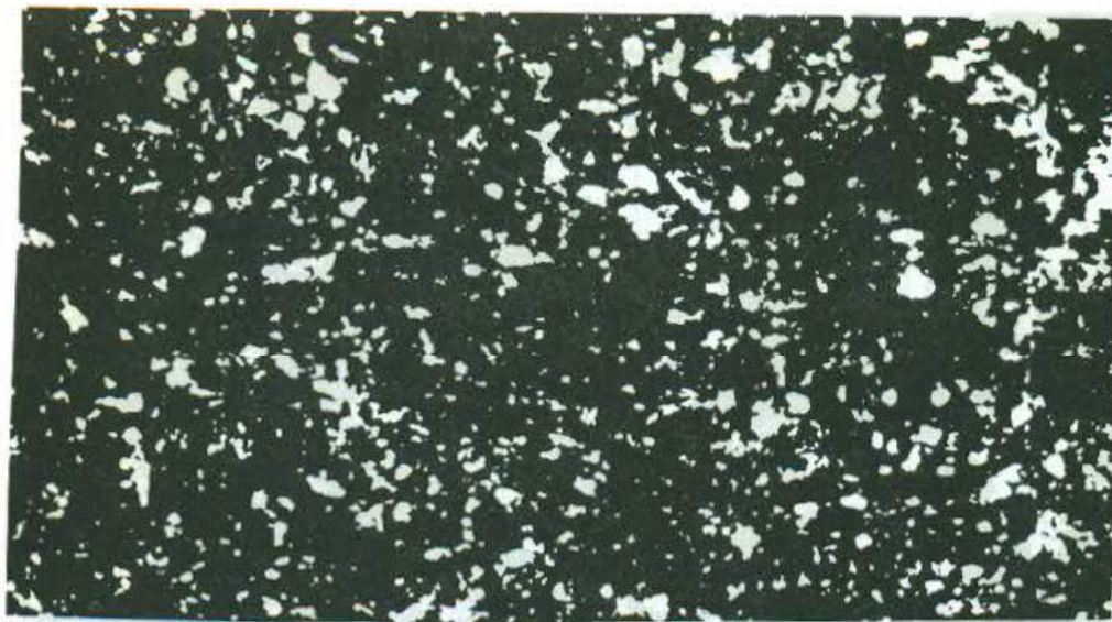
شکل ۳ نمای مقطع نازک مارن زردرنگ (PPL×40).
