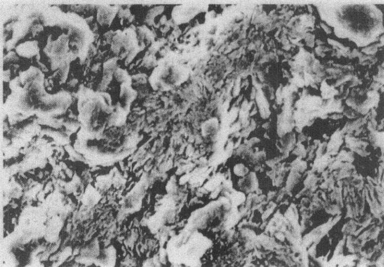
شکل ۲- بلورهای پولکی شکل ایلیت همراه با رسهای آلفان و مونت موریلونیت. نمونه شماره ۱۲۱۸ معدن زنوز، بزرگ نمایی ۱۵۰۰ برابر.
