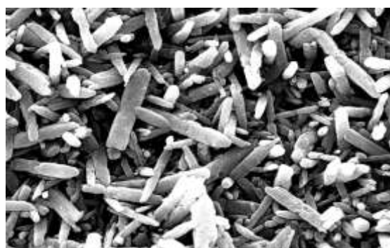
شکل ۶ تصویر میکروسکوپی SEM یک نمونه نیتريد سیلیسیم حکاکی شده با NaOH در دمای 450^\circ\text{C} به مدت ۷ دقیقه.
