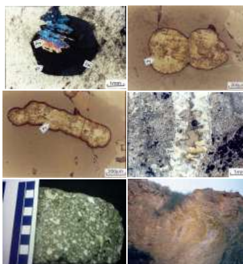
شکل ۳ تصاویر صحرایی، نمونه دستی و میکروسکوپی (a) رگچه‌های ژئوپس در دگرسان‌های روستای انزر که در طول فرایند سوپرژن رودخانه قزل اوزن. (b) نمایی از دگرسان‌های اسید سولفاتی سوپرژن. (c) نمونه دستی از زون دگرسان کالک سیلیکاتی. (d) تصویر میکروسکوپی از کانی اپیدوت که روی کانی‌های کوارتز و پره‌نیت قرار گرفته است (نور XPL). (e) کوارتز با بافت دروزه‌ای. (f) رگچه‌های کلسیتی در درون زون‌های دگرسان حاشیه رودخانه قزل اوزن.
