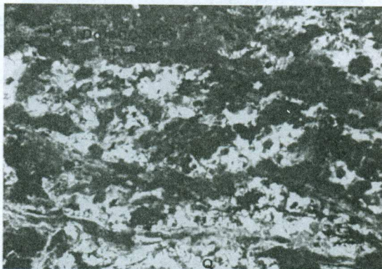
شکل ۲. لیستونیت‌زایی در راستای سطوح شیستوزیته سرپانتینیت‌ها ( \times 12.5 , XPL). انواع کربنات (دولومیت، منیزیت، کلسیت، برونریت و اسمیت زونیت)، کوارتز و موسکویت با XRD در این نمونه تأیید شده است.
