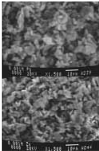
شکل ۶ نیمرخ عرضی نمونه کاتولینیت با غلظت‌های ۰/۰۰۱ مولار فلز سنگین روی و سرب؛ بزرگ‌نمایی ۱۵۰۰ برابر
