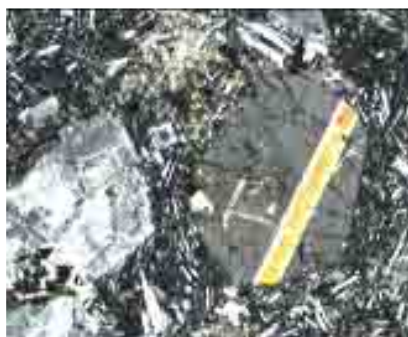
تصویر ۳ درشت بلورهای کلینوپیروکسن (Cpx) و پلاژیوکلاز (Plg) در آندزیت (XPL).
