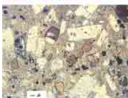
تصویر ۴ بافت پورفیری در داسیت حاوی درشت بلورهای پلاژیوکلاز (Plg) و بیوتیت (Bio) در خمیره ریز دانه تا مخفی بلور (PPL).
