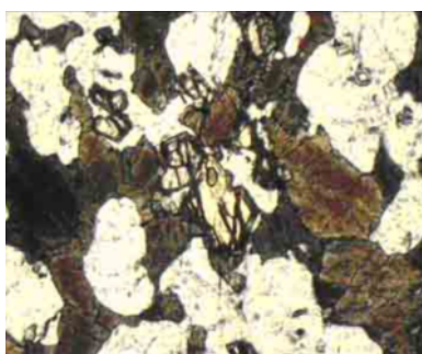
تصویر ۷ تبدیل هورنبلند قهوه‌ای (b.Hb) به هورنبلند سبز (gHb) در برونوم آمفیبولیتی (PPL).
